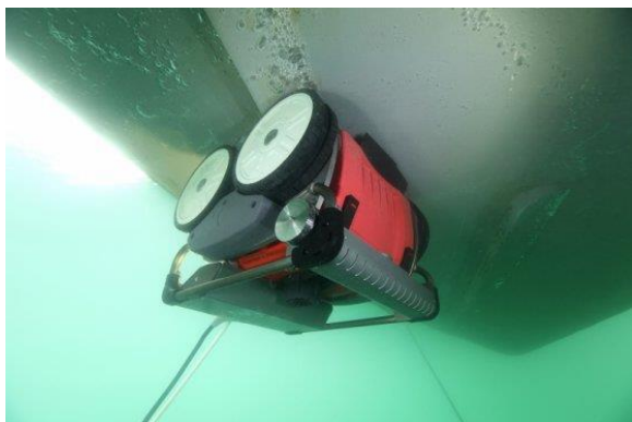
ربات پیشرفته تمیزکاری بدنه کشتی
