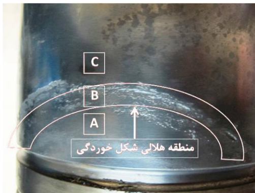
شکل ۴- ایجاد منطقه هلالی شکل خورده شده در قسمت انتهایی استوانه موتور دیزل دریایی
