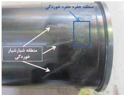
شکل ۵ - مناطق خوردگی حفره حفره و شیارشیار در قسمت بالایی استوانه موتور دیزل دریایی
